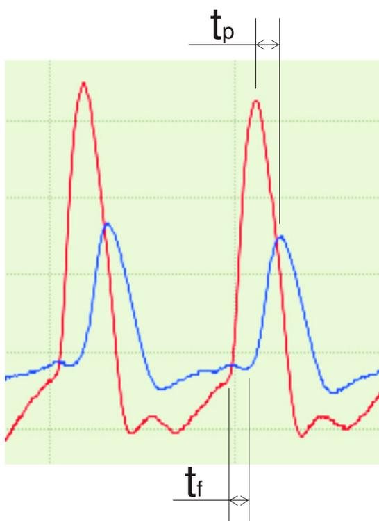
Die von VascAssist aufgenommenen Pulsdruckkurven ähneln den von einem bidirektionalen Doppler aufgenommenen Signalen, häufig lässt sich Mono- Bi- oder Triphasigkeit erkennen.
